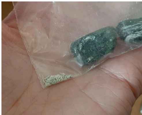
Losse asbestvezels uit de trommelsteen
